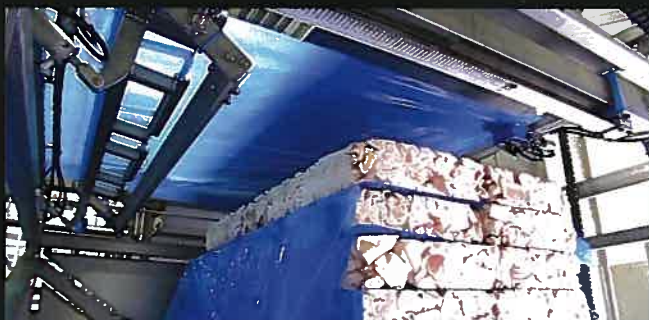
De plaatvriezers worden volautomatisch gepalleteerd
